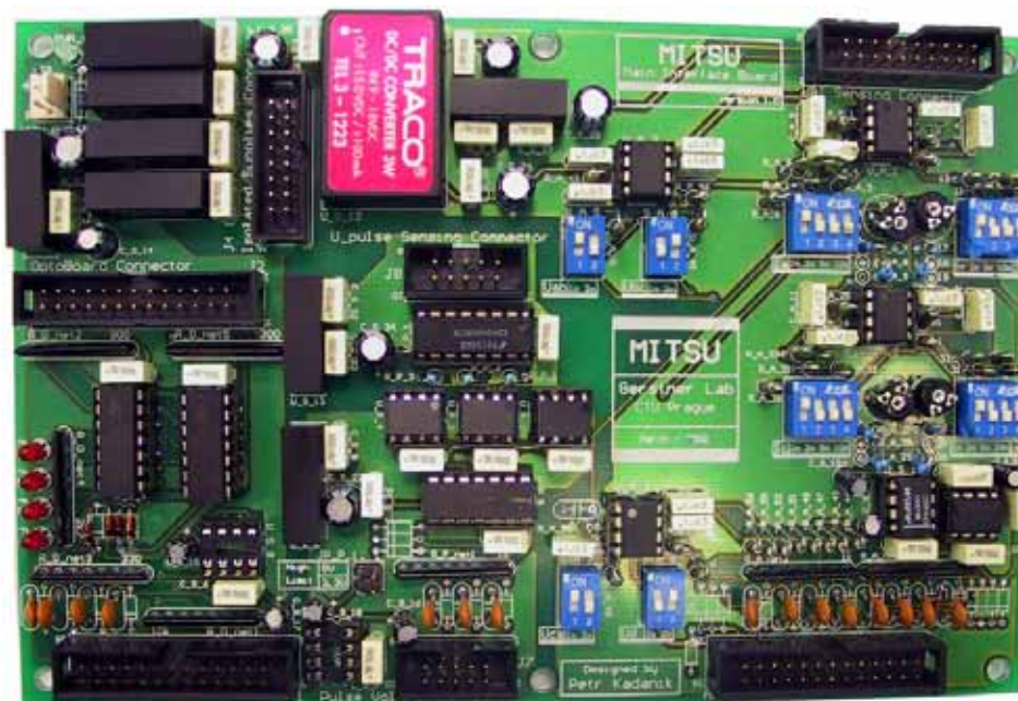
Obr.6-12: Hlavní deska celého rozhraní ( Mitsu Main Board )
